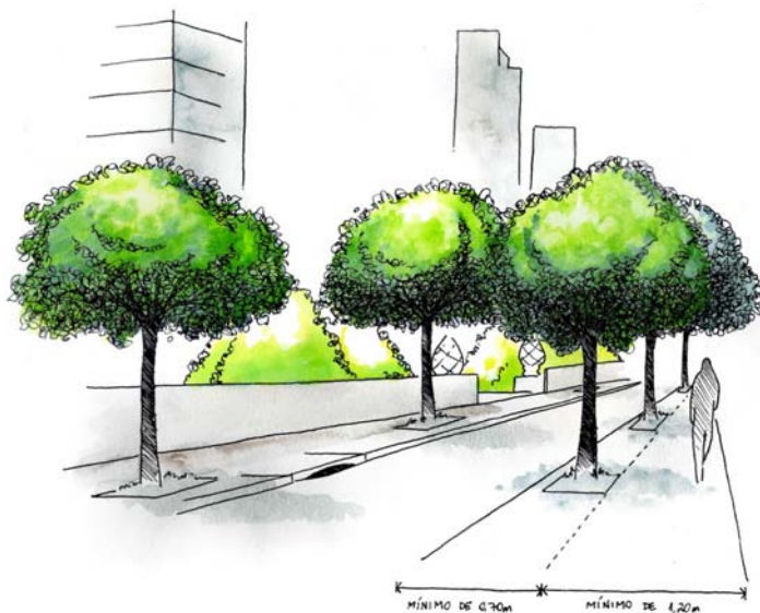
Figura 02. Largura da calçada para arborização
